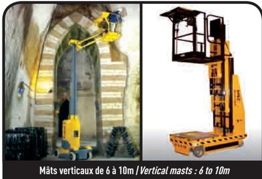
Mâts verticaux de 6 à 10m | *Vertical masts : 6 to 10m*
