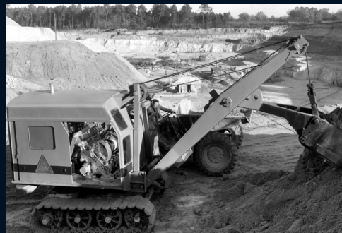
> 1952 : Girochargeur X 50 - Innovant par son système hydraulique : c'est le seul chargeur de ce type ayant été fabriqué en France. The X 50 swing shovel loader, with its innovative hydraulic system: this was the only loader of its kind built in France.
