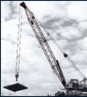
> 1964 : Grue mobile H50 Ingénieuse avec ses 8 vitesses de levage. The ingenious H50 mobile crane with its eight lifting speeds
