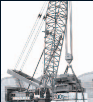
> 1976 : Grue sur porteur GC 20300 - la plus grosse grue sur porteur (Charge de 300 Tonnes). The GC 20300 wheel-mounted crane (with a 300 tons load capacity).
