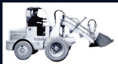
> 1952 : Première petite pelle à commandes pneumatiques avec assistance. The first small shovel with assisted pneumatic controls.
