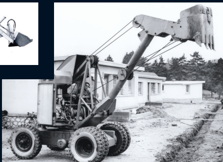
> 1954 : Pelle compacte SK2 - Première pelle compacte au monde sur pneumatique sans déport arrière. The SK2 compact shovel - the world's first tyre-mounted compact shovel with no rear offset.
